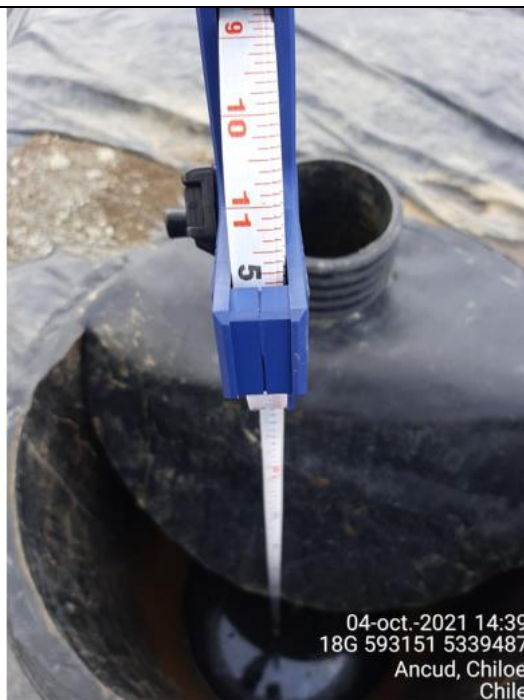
Fotografía N°13: Medición de Niveles de cámaras por Personal Municipal. Tomada: 04 de Octubre del 2021.
